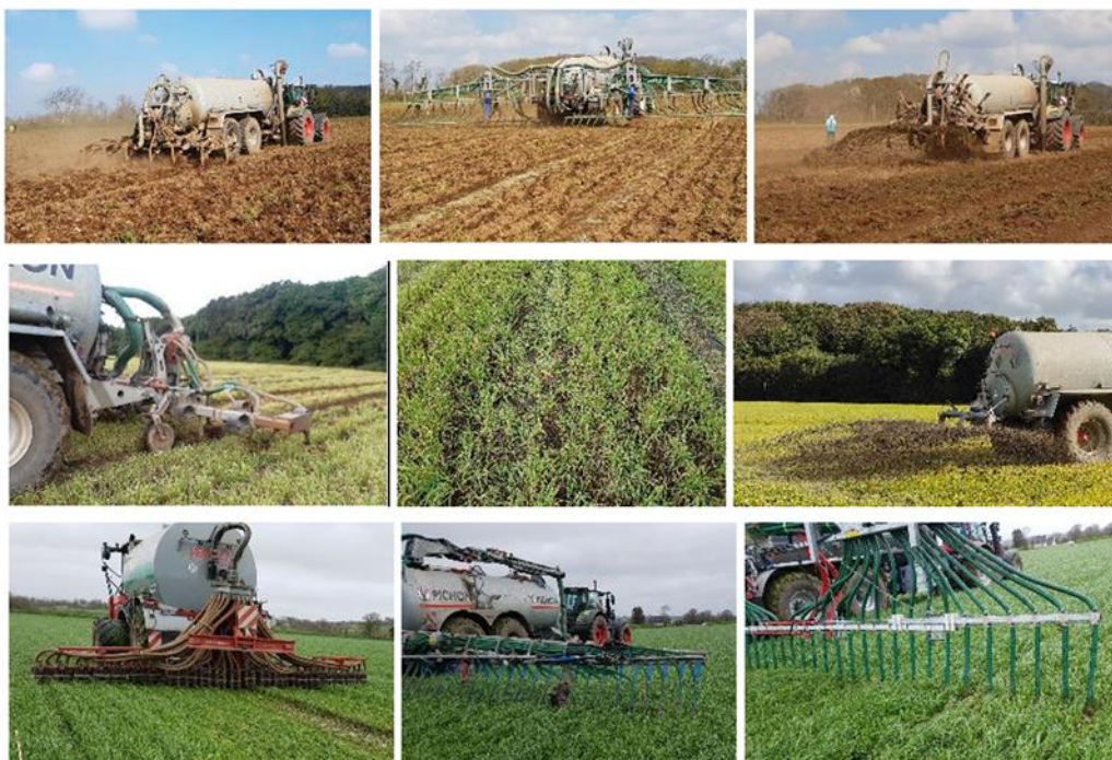
Figure 2 : Matériels d'épandage utilisés sur les plateformes maïs (ligne 1), colza (ligne 2) et prairie (ligne 3). De gauche à droite pour chaque ligne les matériels d'épandage sont : (1) enfouisseur à dents, rampe à pendillards, buse palette ; (2) enfouisseur à dents, état du sol de la modalité après passage du pendillard, buse palette ; (3) automoteur avec enfouisseur prairie, épandeur avec rampe à patins et rampe à pendillards
