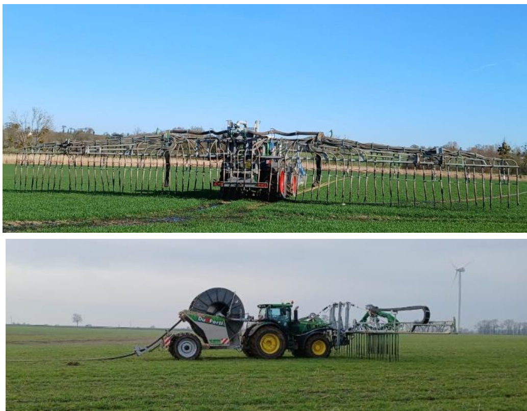
Figure 8 : Epandage au pendillard sans tonne, à gauche : système doté d'un enrouleur, à droite : système cordon (hiver 2025)
