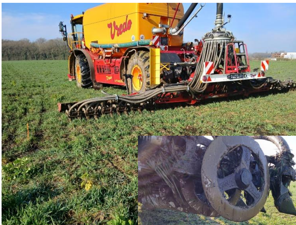
Figure 6 : Epandage avec automoteur avec enfouisseur à disques. Zoom sur les pièces travaillantes (les disques). (Hiver 2025)
