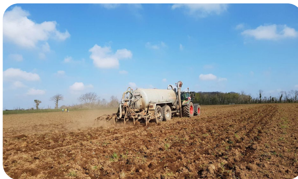
Epandage avec injecteurs à dents avant maïs pour une plateforme expérimentale
