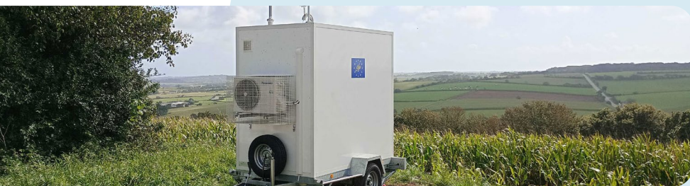
Exemple d'une station mobile de mesures d'ammoniac et de particules fines PM10, installée sur le site Sud.
